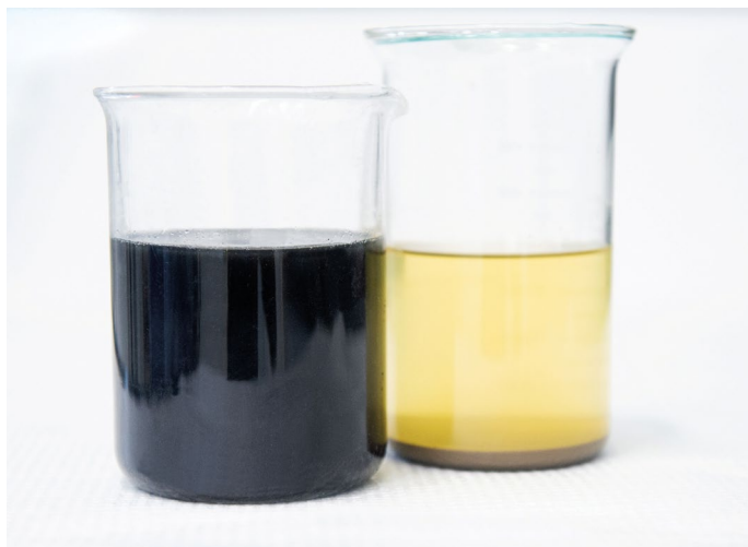
Un échantillon de boues, avant et après le traitement par oxydation hydrothermale.
